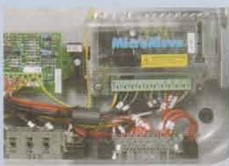
Der MicroMove Frequenzumrichter, Standard bei allen NOVA-Laufkatzen, ist vom Werk voreingestellt.
